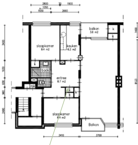
In deze kast plaatsen we de unit van de warmte terugwin installatie
